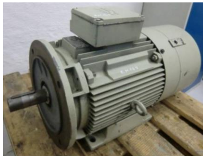
Abbildung 26: Elektromotor (Lüftungshaube am rechten Bildrand) 48
