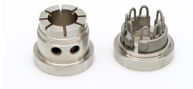
Abbildung 46: Spritzguss-Formeinsatz mit additiv gefertigten Kühlkanälen 67
