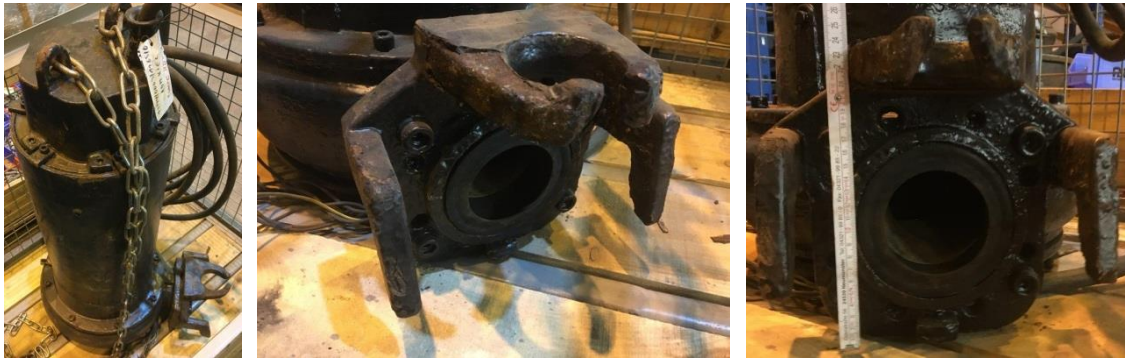
Abbildung 29: Sickerwasserpumpe (links); Klauenkupplung (Mitte); Bauteilabmessungen (rechts) 51
