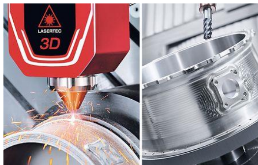
Abbildung 2: Additive Fertigung des Rohlings (links) und spanende Nachbearbeitung des Rohlings (rechts) 10
