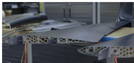
Abbildung 22: Wabenstruktur eines optimierten Flügels, mittels AM hergestellt 43
