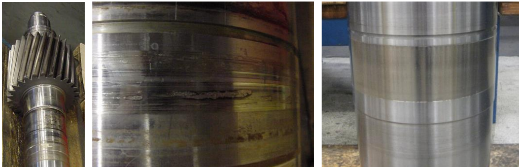
Abbildung 42: Schadhafte Ritzelwelle (links und Mitte); Oberfläche nach der Reparatur (rechts) 64
